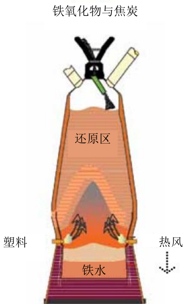
图 4a 在高炉中使用终端用户产生的塑料废弃物
